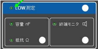
終端SWを押下すると被測定回線を終端しますのでスピーカで音（DT等）を確認下さい。
